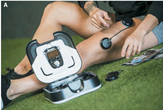
Рис. 6. Рабочие насадки: А — контактные электроды (электрическая миостимуляция), Б — изолированная катушка индуктивности (магнитная миостимуляция)
